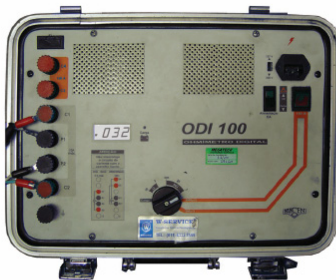
Fig 41 Microhmímetro tipo ODI 100 – Nansen (medidor de resistência ôhmica dos enrolamentos)
