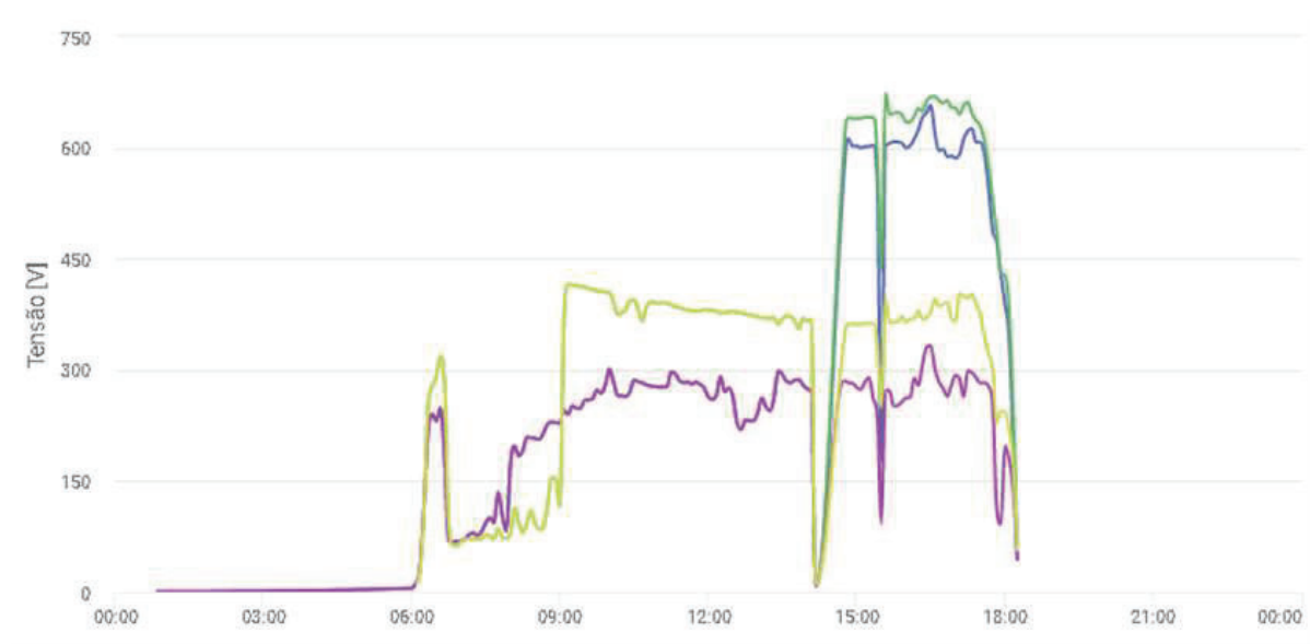
Figura 5: Monitoramento da tensão de operação de 4 strings em um sistema fotovoltaico, estando as strings organizadas em 2 grupos com 2 strings em paralelo.
